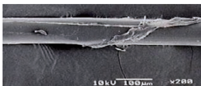
ダメージを受けた糸(モノフィラメント)の顕微鏡下写真
